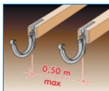
Крепление к стропилам
