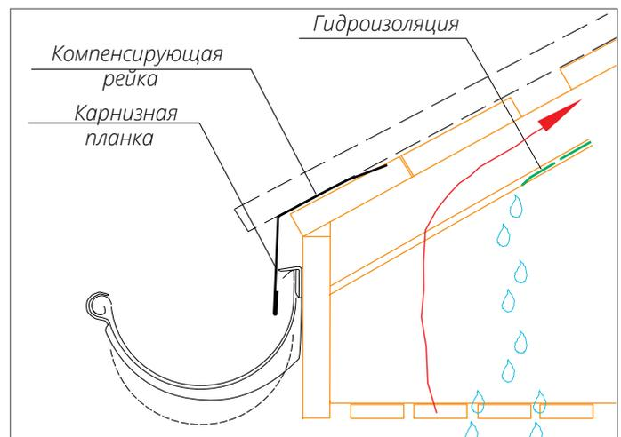
**Внимание!** Для корректного монтажа коротких крюков водосточных систем Grand Line 125/90 и 150/100 лобовая доска должна быть обрезана вертикально.
