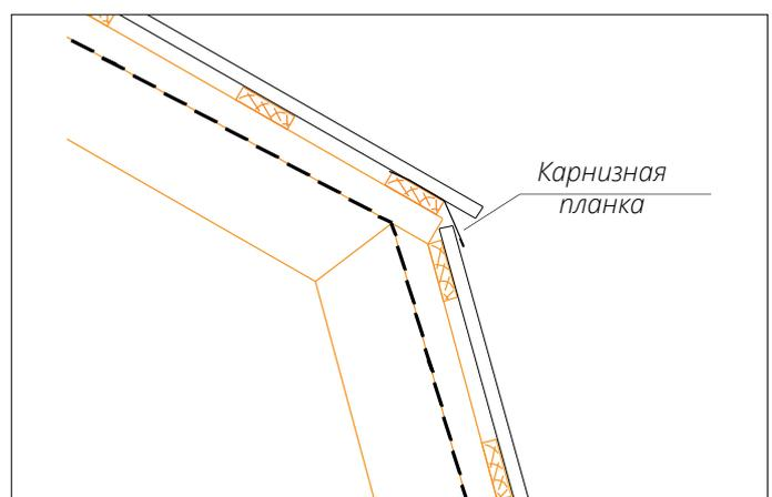
■ Верхняя доска обрешетки и листы профнастила не должны доходить до стены на 50–80 мм для обеспечения функционирования подкровельной вентиляции. В случае небольшого угла наклона ската для предотвращения задувания снега в особо ответственных случаях смонтируйте между профнастилом и Планкой примыкания аэрэлемент конька, заведя один из краев аэрэлемента конька на стену.
